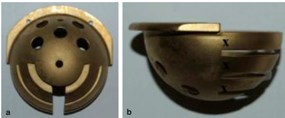
Abb. 1: Die anisotrope Vektorpfanne a) Ansicht von oben b) Ansicht von unten (x: Ursprung der flexiblen Rippen).
