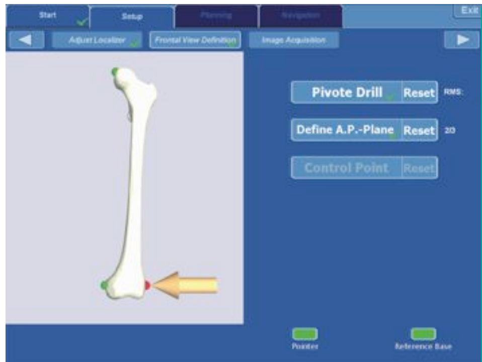
Abb. 1: Erfassung von drei Referenzpunkten durch Abtastung zur Datenerfassung der Freihandnavigation des Führungsdrahts und zur Generierung des Knochenmodells: Epicondylus medialis et lateralis transkutan und Hüftkopf.
